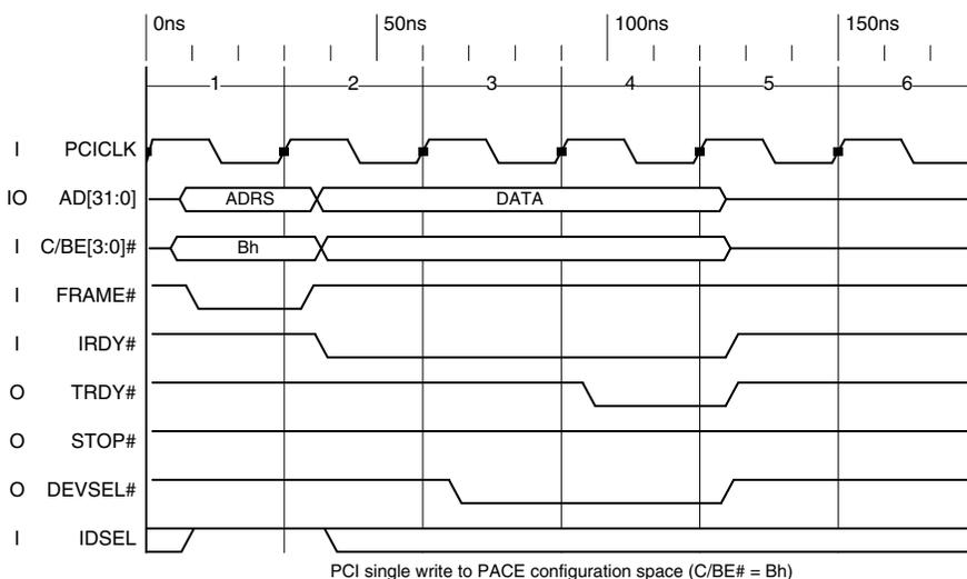
FIGURE 14. PCI SINGLE WRITE TO CONFIGURATION SPACE
