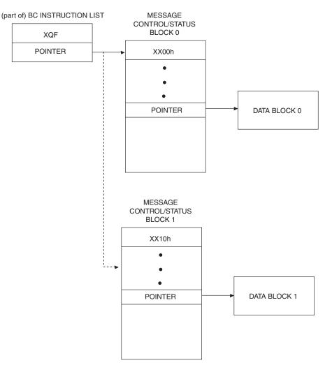
FIGURE 4. USE OF EXECUTE AND FLIP (XQF) OPERATION
