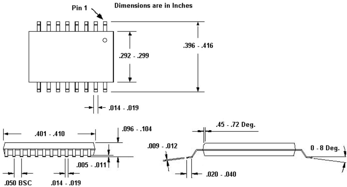
**16L SOIC WB Package Dimensions**
